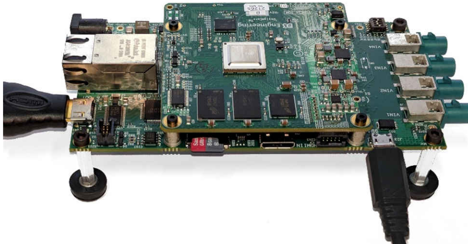
图 3-1. USB Micro B 线缆连接到串行控制台调试端口
