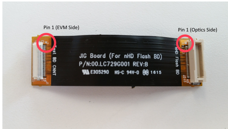
图 2.0.2 nHD 光学引擎柔性电缆连接器概述
