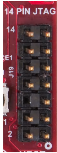
图 2-21. 14 引脚 JTAG 连接器
