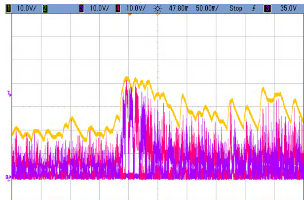
图 3-2. 有 H 类运行时的音频输出和升压电压
