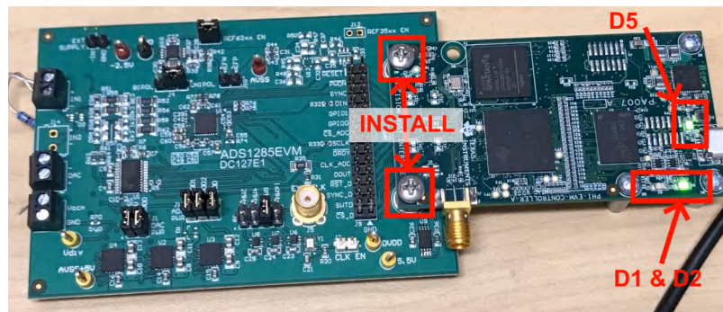
图 2-1. ADS1285EVM-PDK 硬件设置和 LED 指示灯
