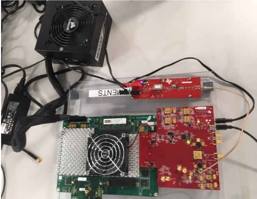
图 6-5. Alpha Data 电路板与 ADC12DJ3200 CVAL EVM 连接设置
