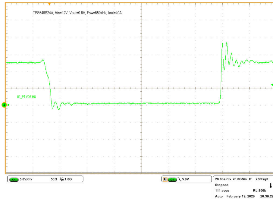
图 7-10. 高侧 MOSFET V_{DS}
