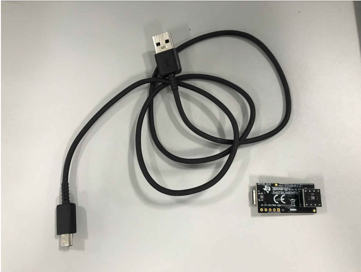
图 1-1. OPT3004DTSEVM 套件附带的硬件
