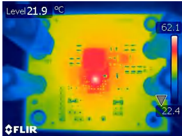
图 5-5. 热像图： V_{IN} = 6V ， I_{OUT} = 1A ， V_{BIAS} = 6V ，无强制空气冷却
