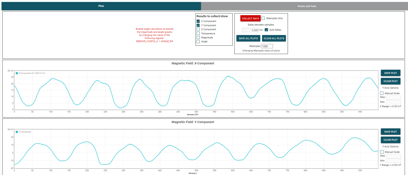
图 4-17. 移动控制手柄后 X 和 Y 通道 GUI 图的示例
