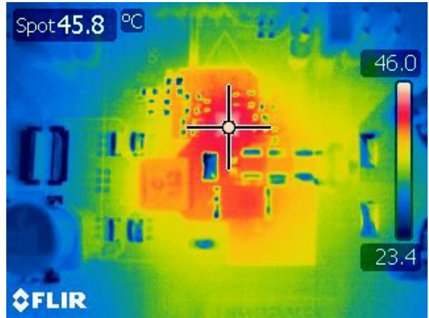
图 5-4. 热性能图像, V_{IN} = 3V , I_{OUT} = 0.6A , V_{BIAS} = 12V , 无强制空气冷却
