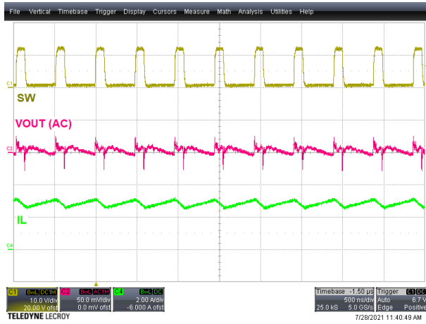
图 5-7. 稳态, V_{IN} = 3V , I_{OUT} = 0.6A
