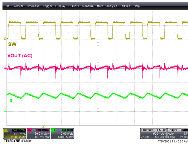
图 5-9. 稳态, V_{IN} = 9V , I_{OUT} = 1.6A
