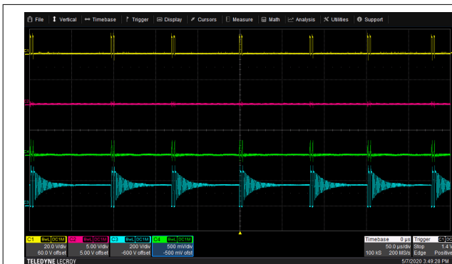
图 8-13. SBP1 工作模式下的典型波形，黄色 = PWML，红色 = PWMH，绿色 = 变压器初级绕组电流 (0.2V/A)，蓝色 = 开关节点电压
