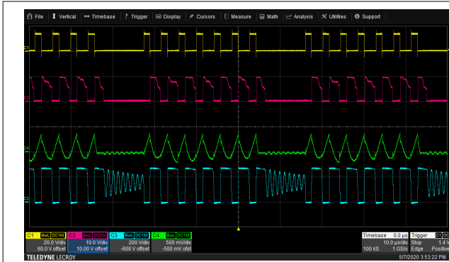
图 8-11. ABM 工作模式下的典型波形，黄色 = PWML，红色 = SR MOSFET 的 Vgs，绿色 = 变压器初级绕组电流 (0.2V/A)，蓝色 = 开关节点电压
