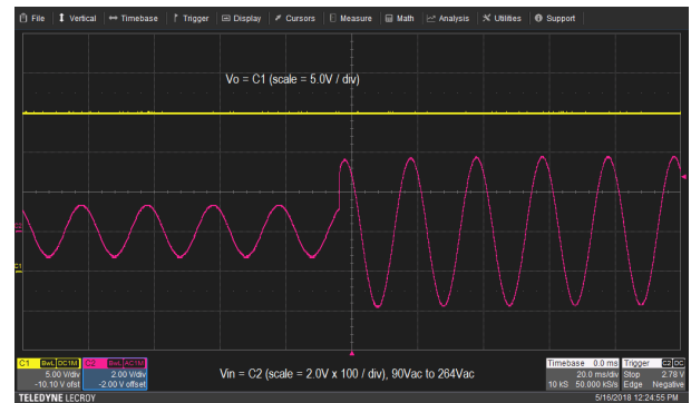
图 8-22. 无负载条件下线路瞬态的输出电压响应。
