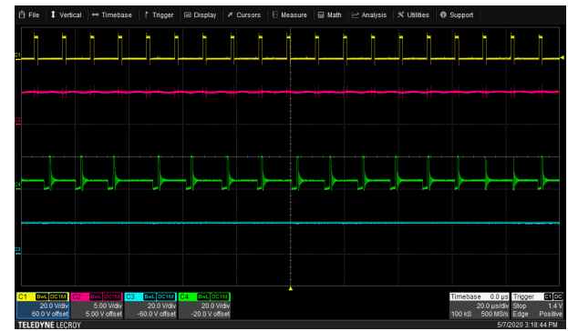
图 8-30. 5V_{OUT} 且满载时的升压操作 (黄色 = PWML, 红色 = BIN, 绿色 = BSW, 蓝色 = VDD)
