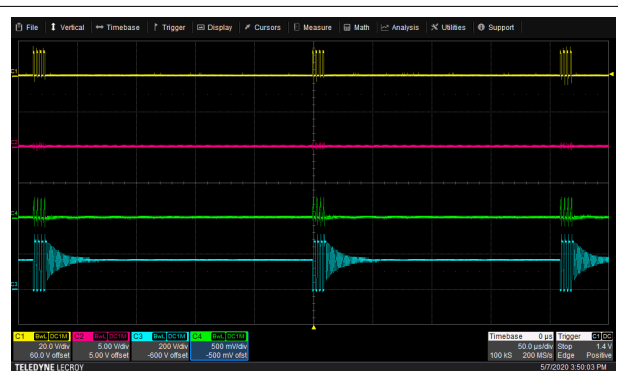
图 8-14. SBP2 工作模式下的典型波形，黄色 = PWML，红色 = PWMH，绿色 = 变压器初级绕组电流 (0.2V/A)，蓝色 = 开关节点电压
