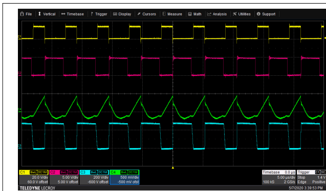
图 8-9. AAM 工作模式下的典型波形, 黄色 = PWML, 红色 = PWMH, 绿色 = 变压器初级绕组电流 (0.2V/A), 蓝色 = 开关节点电压
