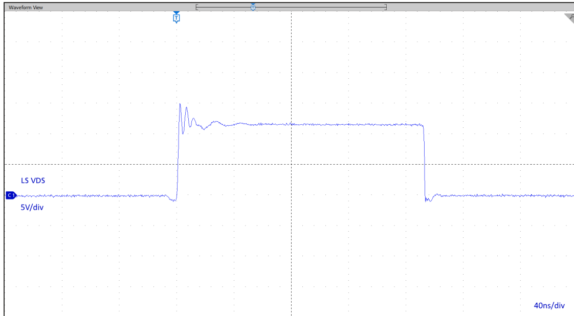
图 7-8. 低侧 MOSFET V_{DS}
