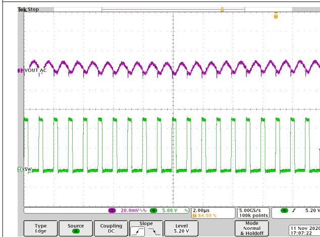
图 3-17. U2 输出纹波，空载
