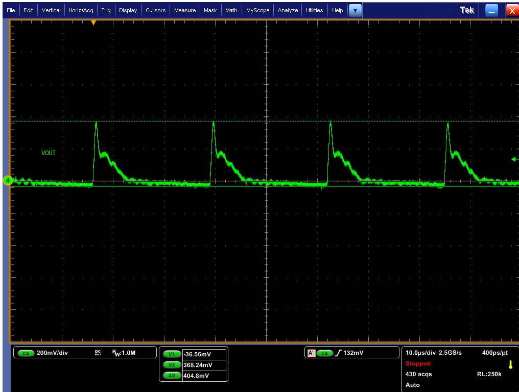
图 5-18. 输出电压纹波 : VIN = 1000V , 负载 = 2.7A
