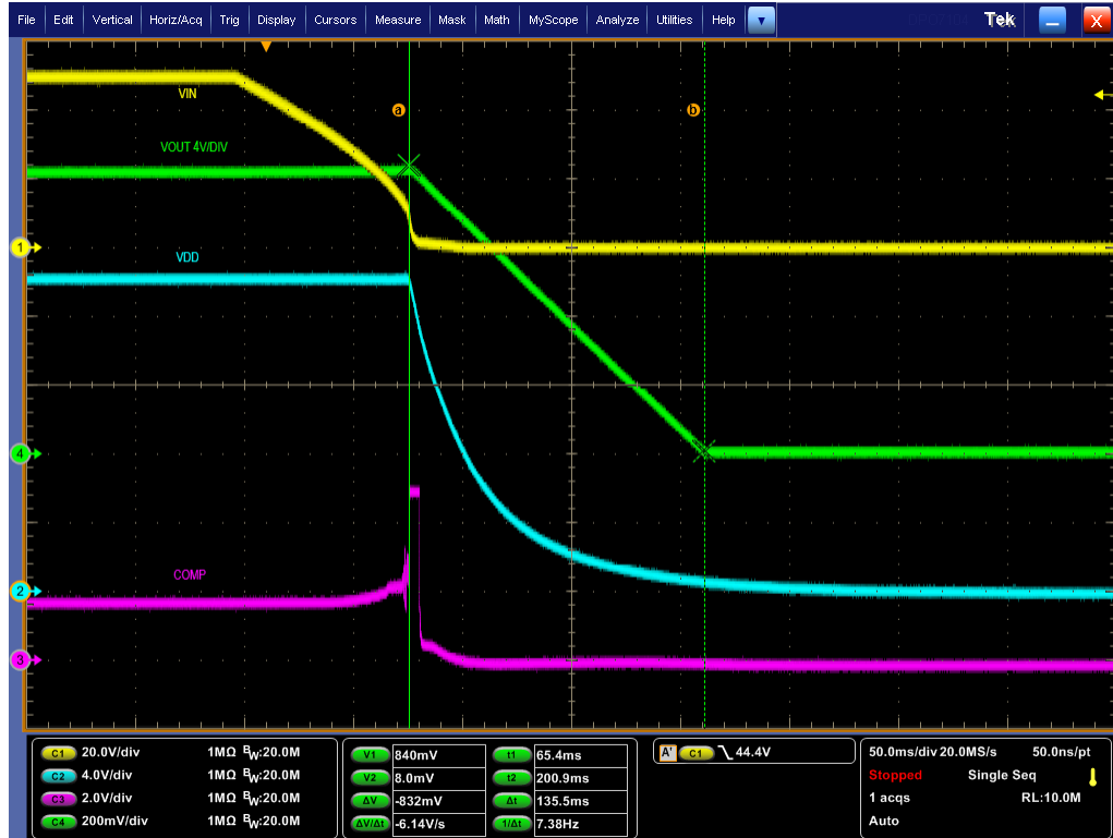
图 5-11. 关断，VIN 移除：VIN = 50V，负载 = 0.25A
