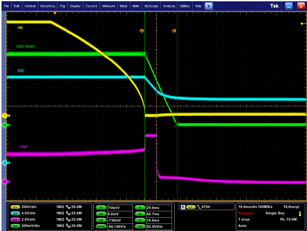
图 5-14. 关断，VIN 移除：VIN = 1000V，负载 = 2.7A
