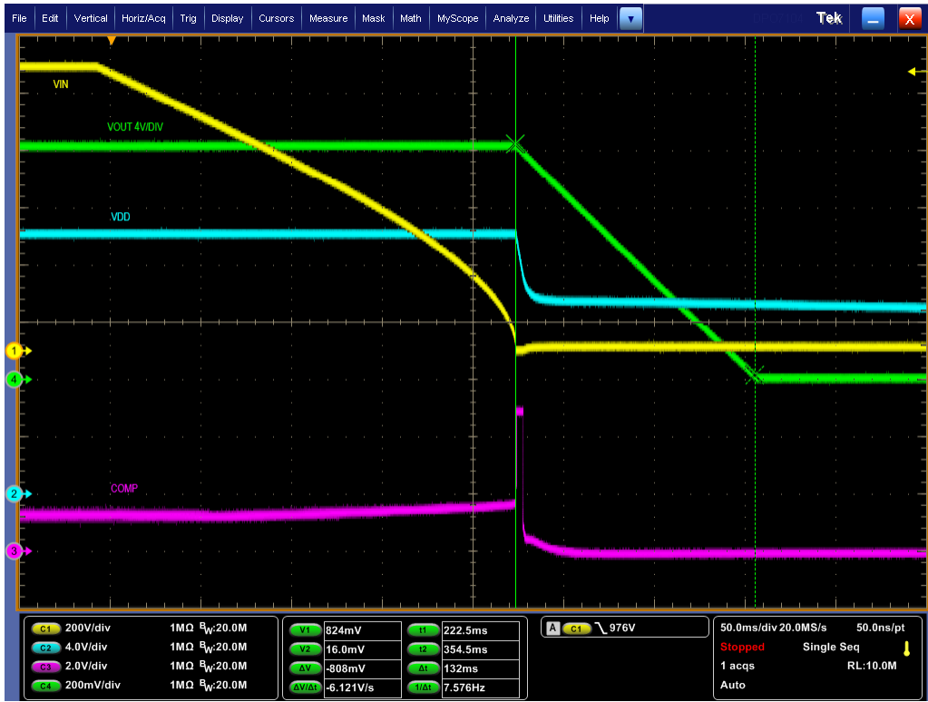
图 5-13. 关断，VIN 移除：VIN = 1000V，负载 = 0.25A
