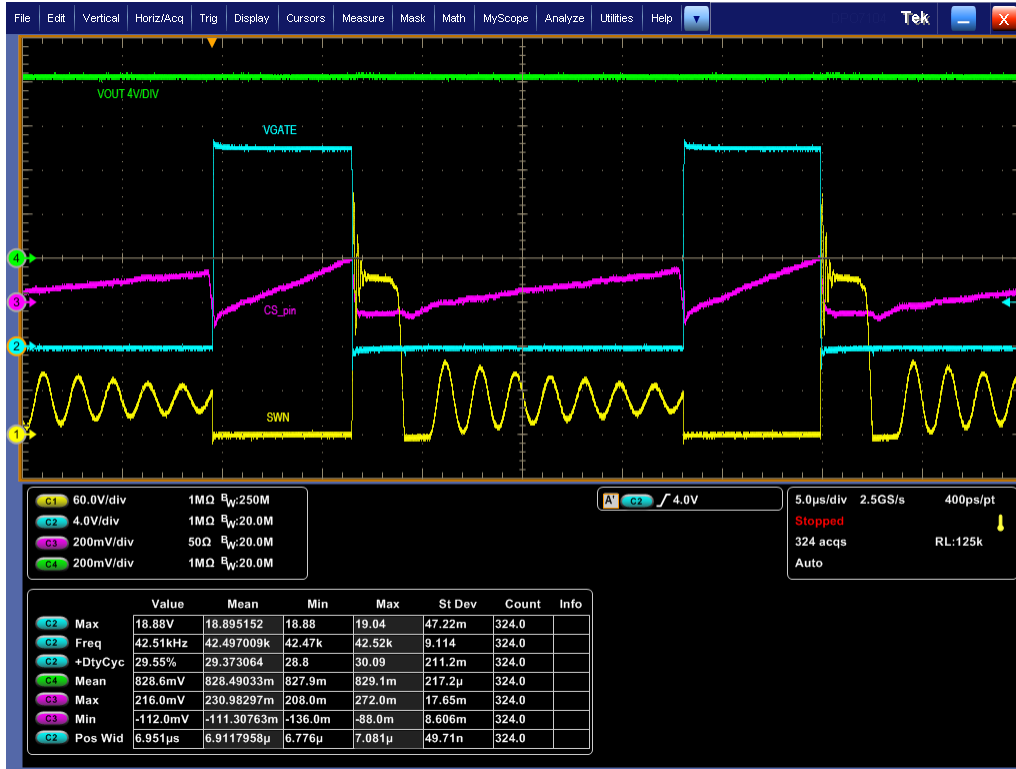
图 5-19. 稳态 : V_{IN} = 50V , 负载 = 0.25A
