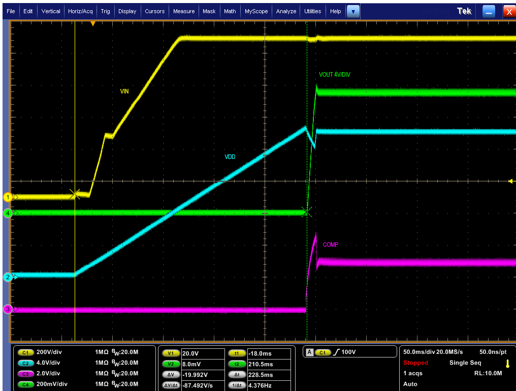
图 5-10. 启动 4 : VIN = 1000V , 负载 = 2.7A
