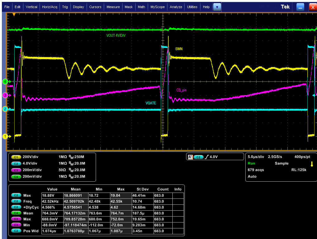
图 5-22. 稳态 : VIN = 1000V , 负载 = 2.7A
