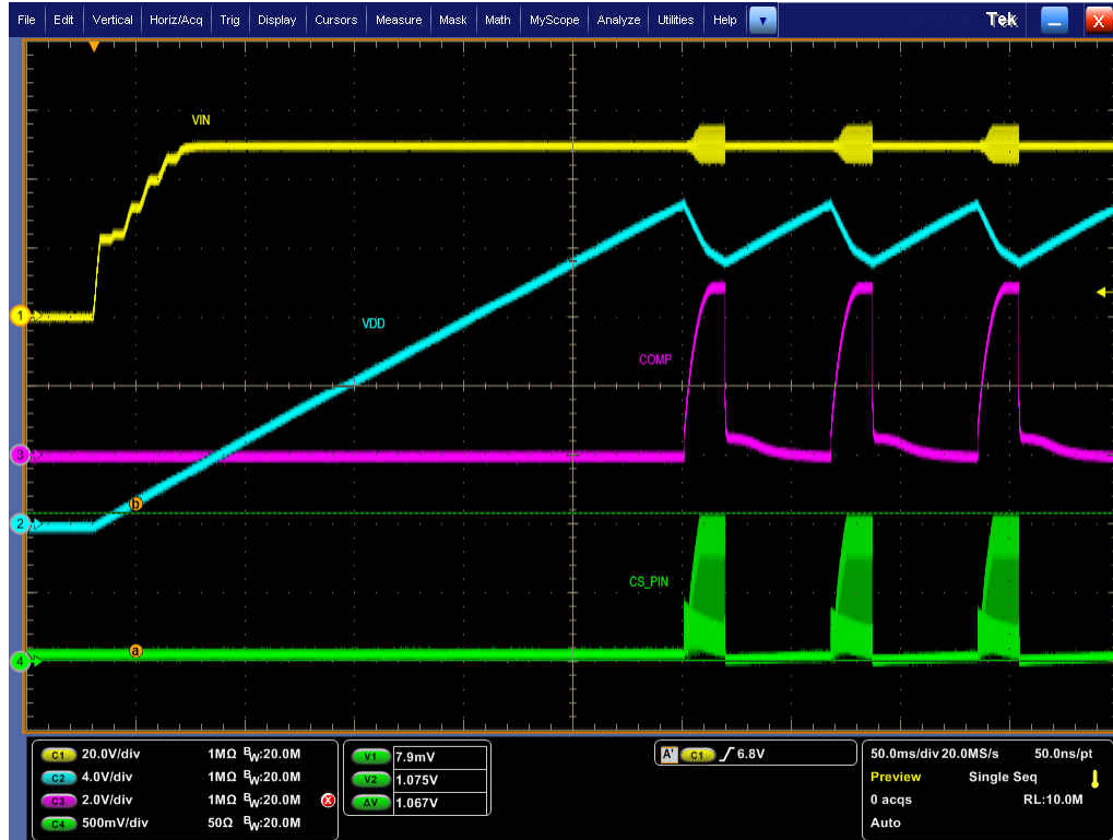
图 5-27. 50VIN，在输出对地短路的情况下启动
