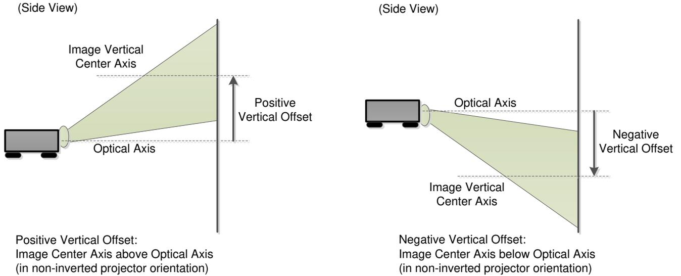
图 3-16. 光 DMD 偏移数据符号的确定方式
