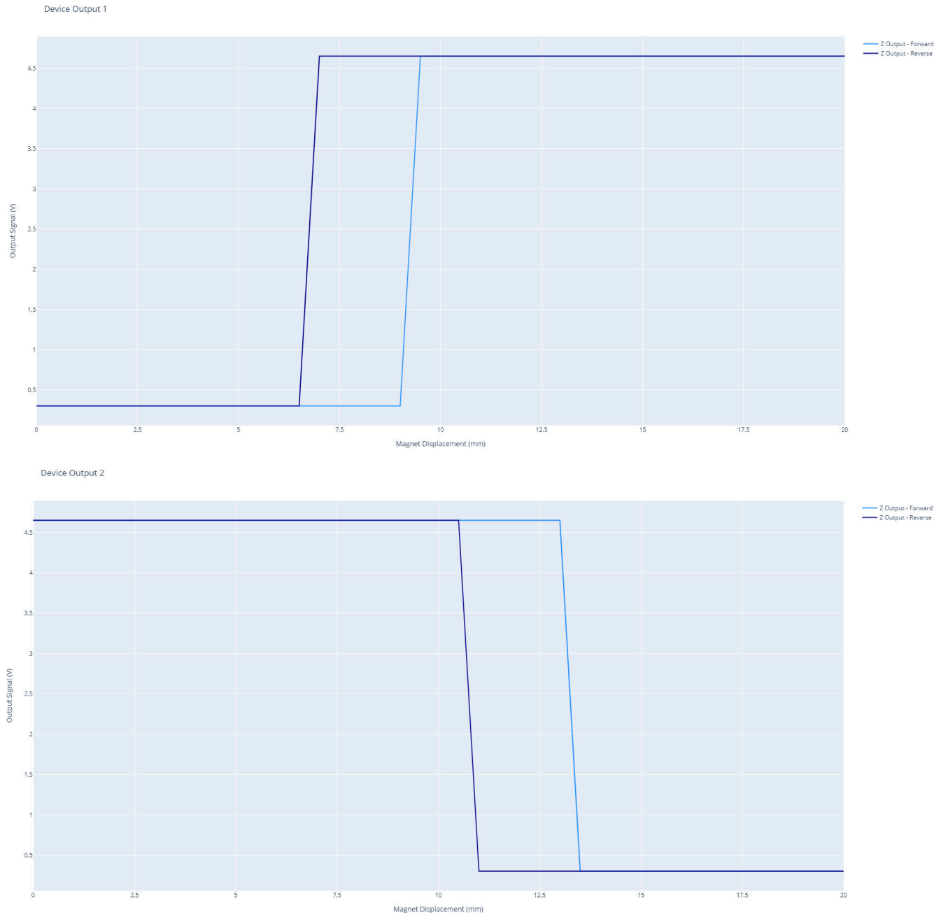
图 5-8. 开关传感器输出
