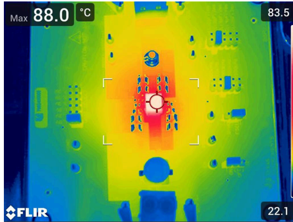
图 3-21. U1 热性能，20A 负载
