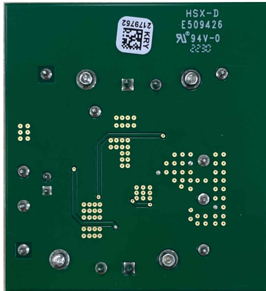
图 5-5. TPS562242EVM 电路板 (底视图)
