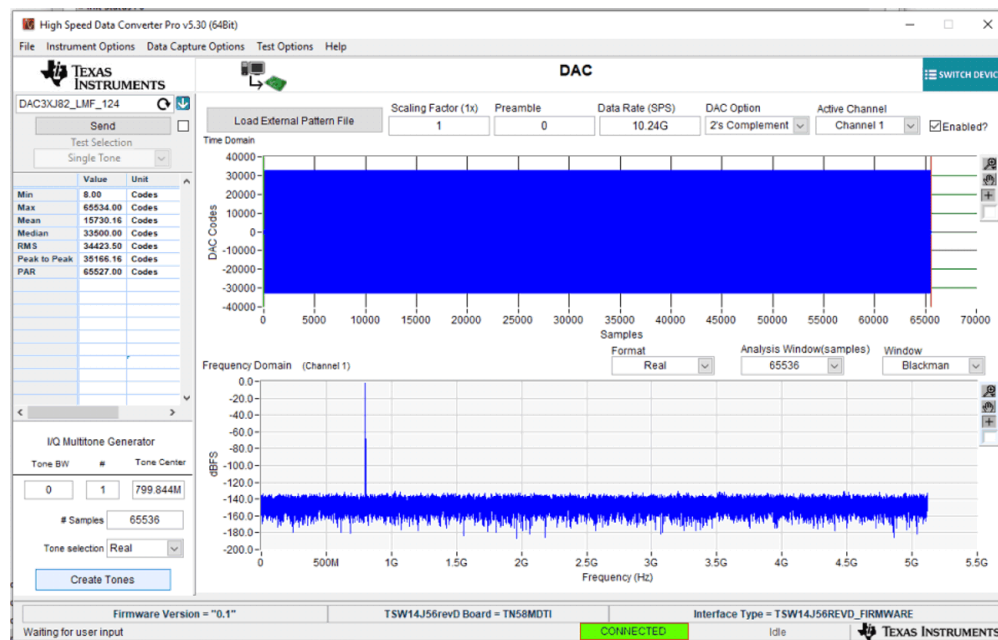
图 5-4. TSW1400 输出数据到 DAC EVM
