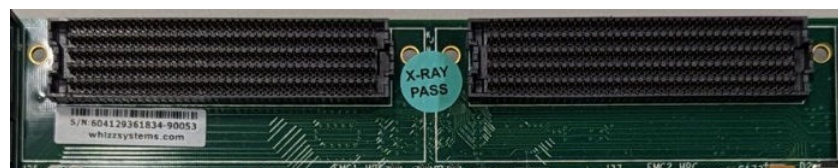
图 3-19. AMD Xilinx VC-707 HPC FMC 电缆母连接器
