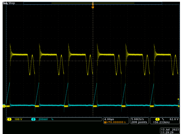
图 3-16. Vin = 265Vac , Vout = 15V
