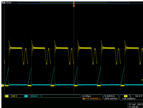
图 3-15. Vin = 230Vac , Vout = 15V
