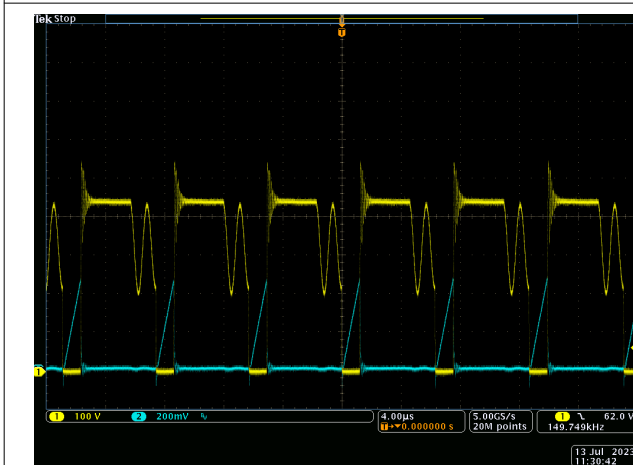
图 3-11. Vin = 230Vac , Vout = 20V
