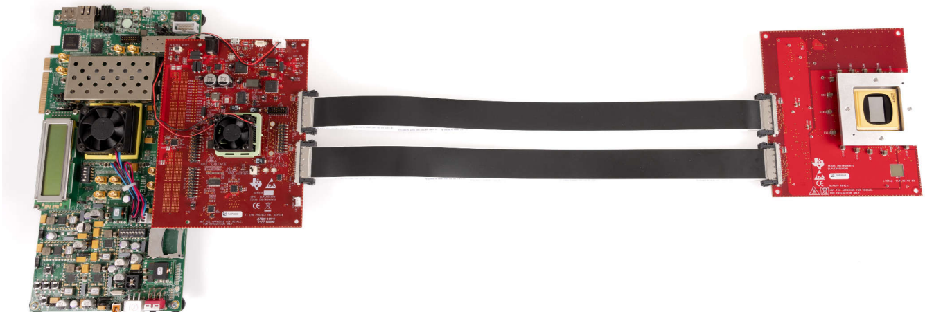
图 2-6. 带 AMD EVM 的完全组装 DLPLCRC964EVM
