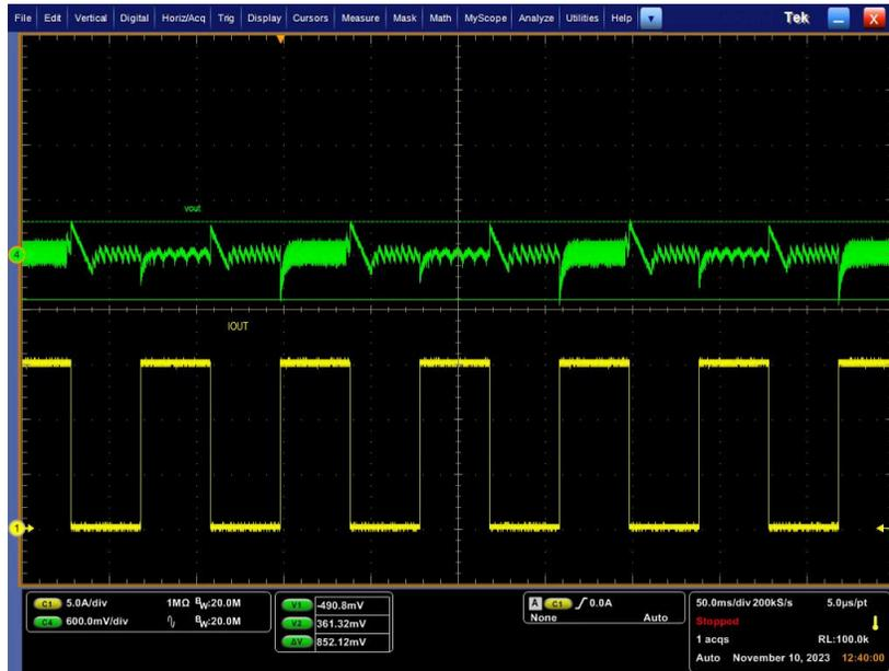
图 3-8. 10mA 至 15A 瞬态 ( Ch4 =  $V_{OUT}$  交流耦合 ; 通道 1 =  $I_{OUT}$  )
