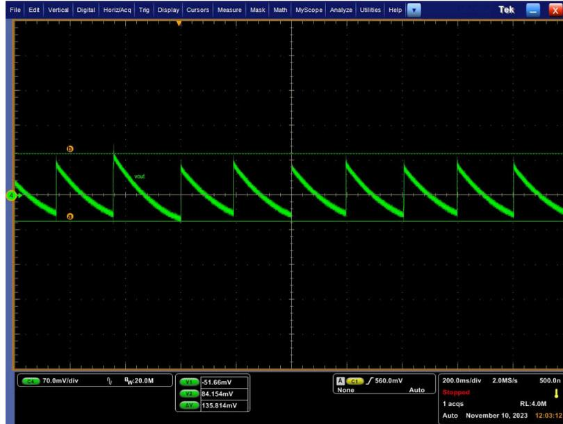
图 3-6. 无负载 (0A) 输出纹波 (Ch4 = V<sub>OUT</sub>)
