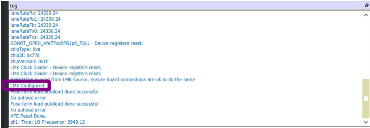
图 4-13. 在 AFE77xxD Latte GUI 中确认 LMK 配置
