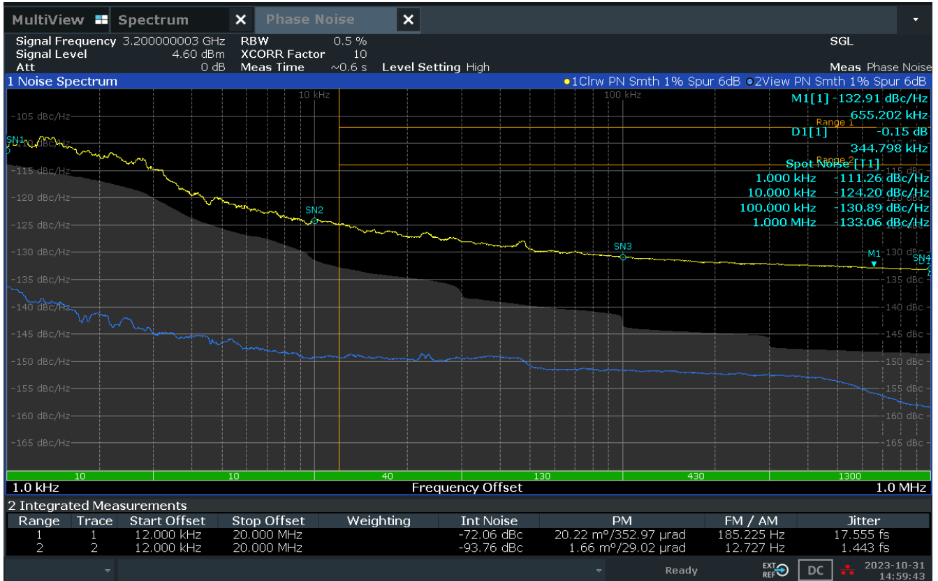
图 4-4. 800MHz 4 倍频模式信号分析仪图
