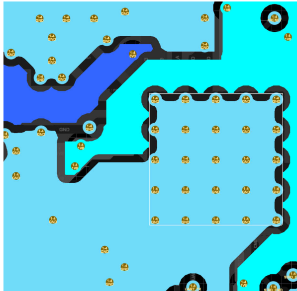
图 3-14. 电源层的参考布局
