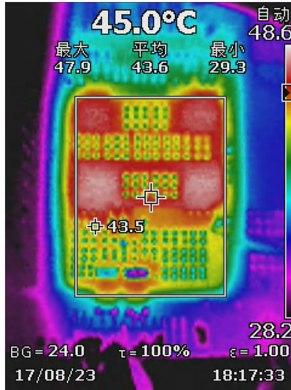
图 4-16. 放电电流为 15A 时的热像图
