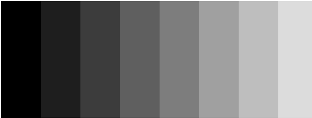
图 3-2. 固定步长水平斜坡测试图形示例
