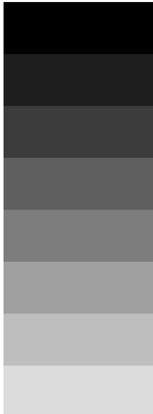
图 3-3. 固定步长垂直斜坡测试图形示例
