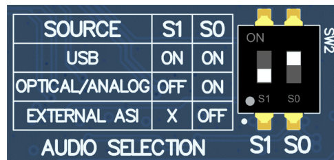
图 2-4. AC-MB 光学或辅助模拟音频输入设置
