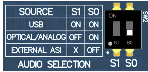
图 2-5. AC-MB 外部音频接口设置
