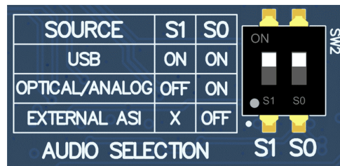
图 2-3. AC-MB USB 音频设置
