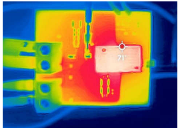
图 3-4. 稳态后 EVM 的热捕获
