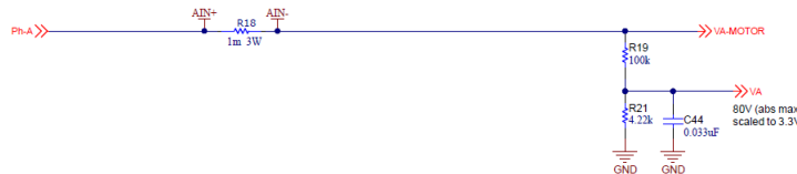
图 3-4. A 相电压检测电路
