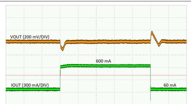
图 3-6. 负载瞬态, 12V<sub>IN</sub>, 3.3V<sub>OUT</sub>, I<sub>OUT</sub> = 60mA 至 600mA, 压摆率 = 1A/μs (自动)
