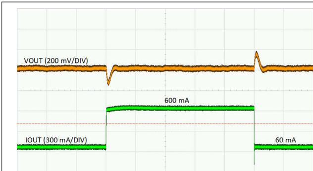
图 3-5. 负载瞬态, 12V<sub>IN</sub>, 3.3V<sub>OUT</sub>, I<sub>OUT</sub> = 60mA 至 600mA, 压摆率 = 1A/μs (FPWM)
