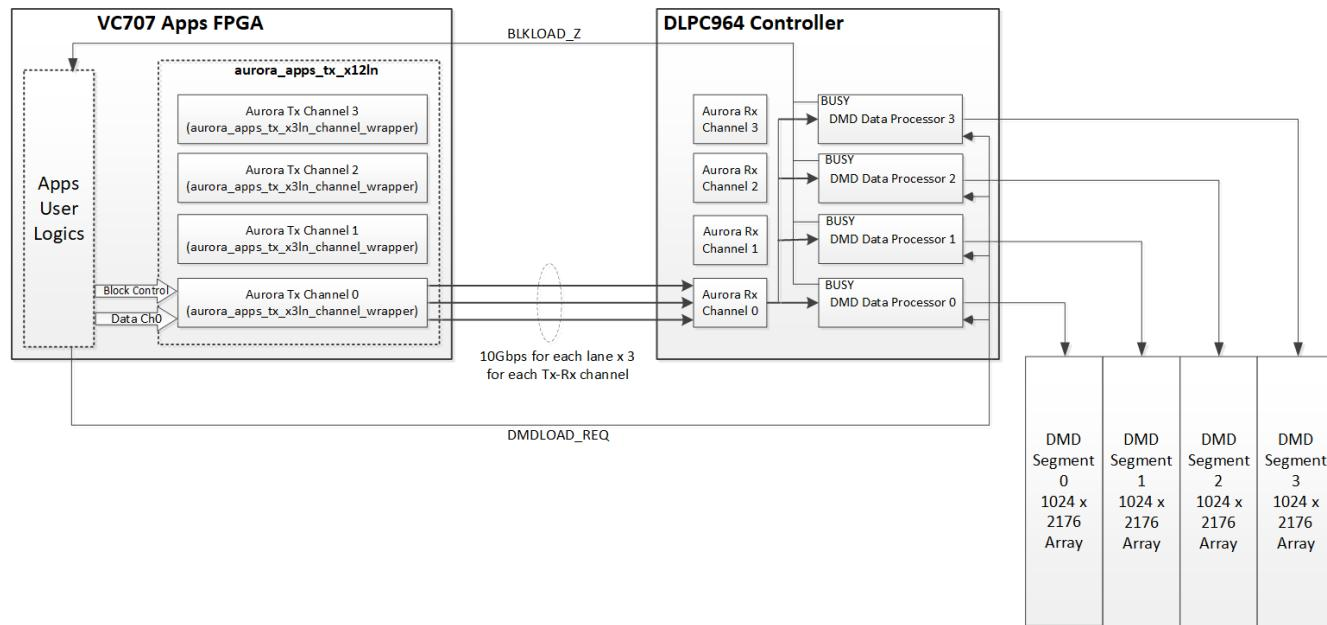
图 4-23. 单通道运行模式的系统方框图
