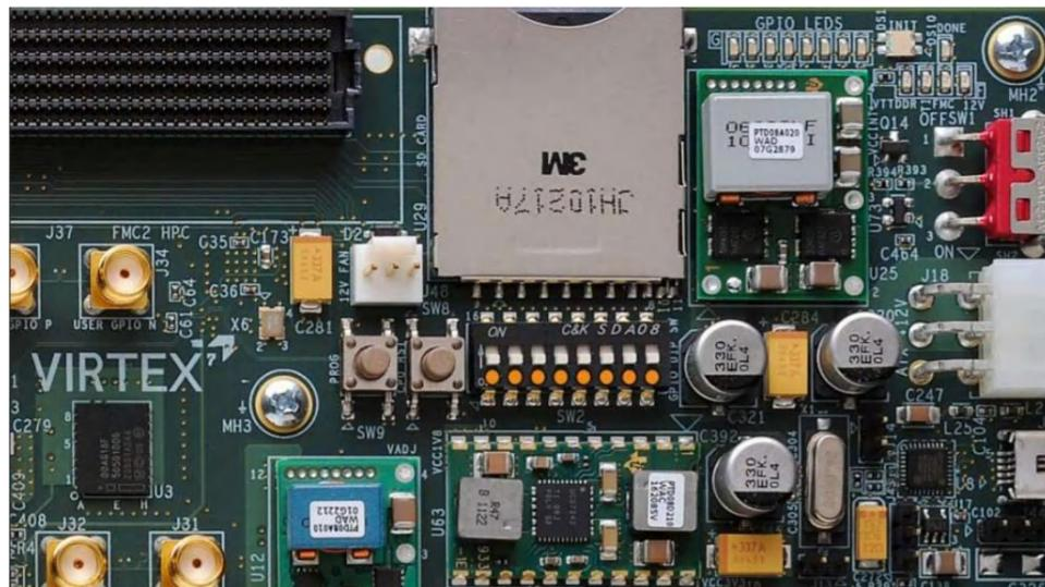
图 4-10. GPIO DIP 开关 (VC707)
