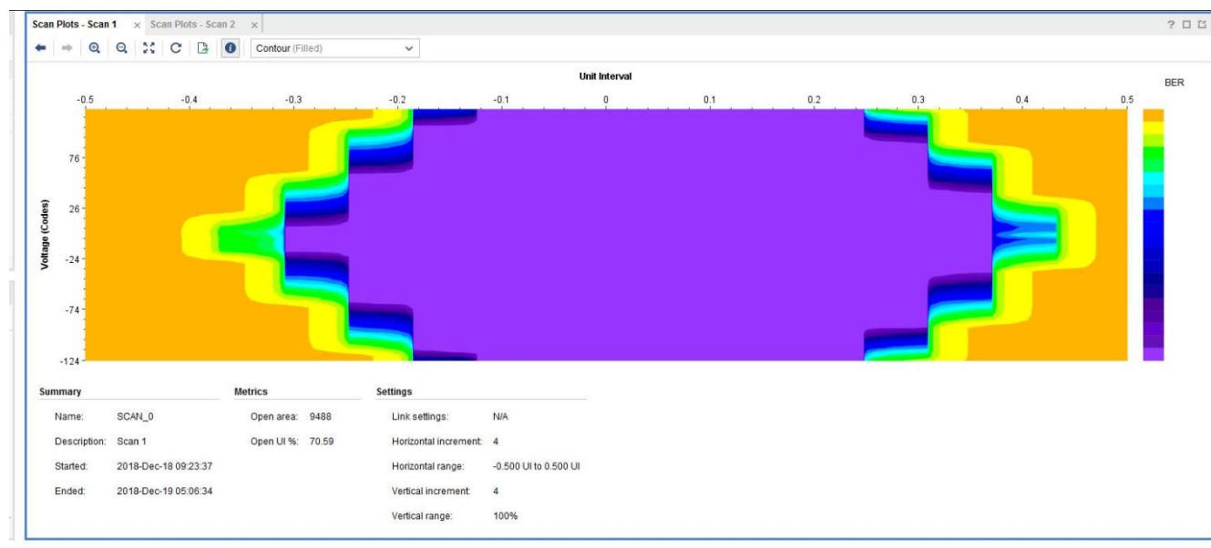
图 4-27. 使用 TI EVM 硬件时 Aurora Channel0 Link0 的 IBERT 眼图扫描
