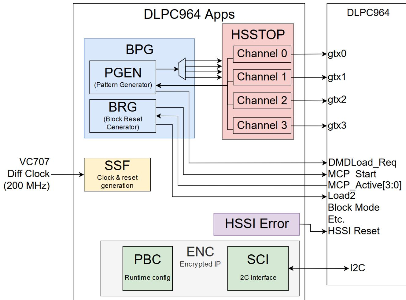
图 2-1. Apps FPGA 硬件方框图
