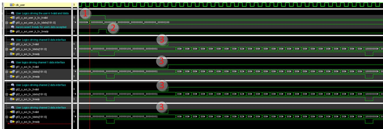
图 4-18. 块以块控制字开始的波形
