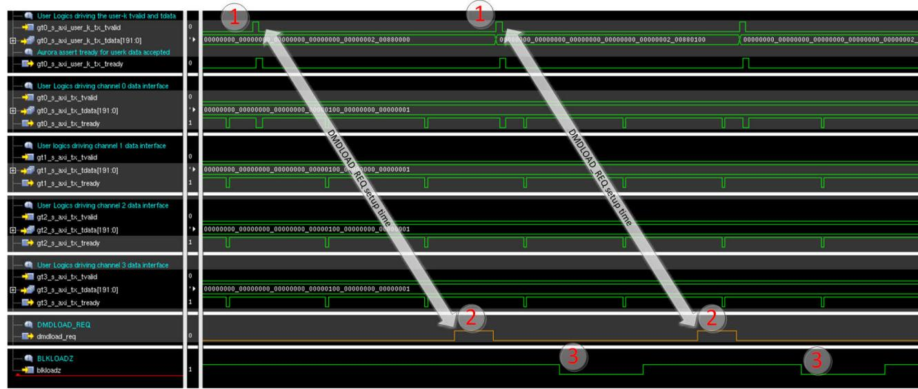
图 4-22. 块置位操作的 DMDLOAD\_REQ 建立时间
