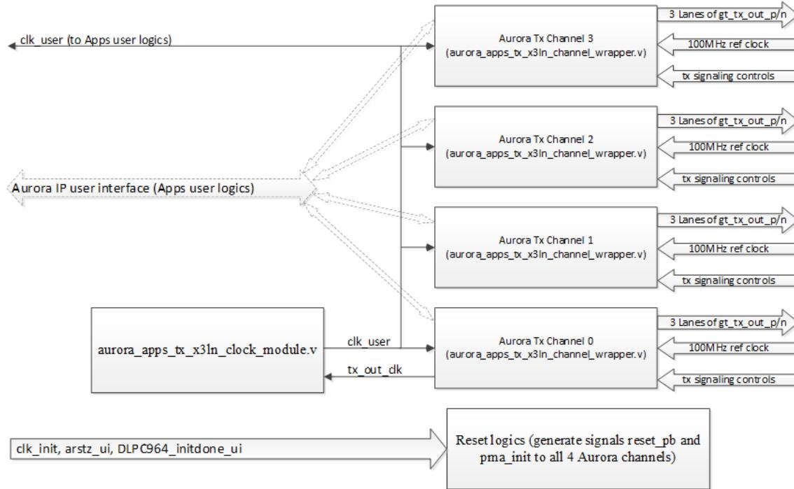
图 4-17. `Aurora_apps_tx_x12ln.v` RTL 方框图
