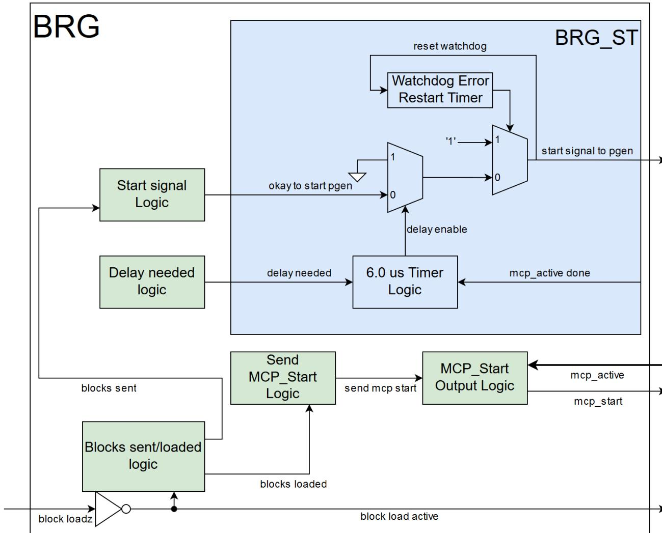
图 2-3. BRG 模块硬件方框图
