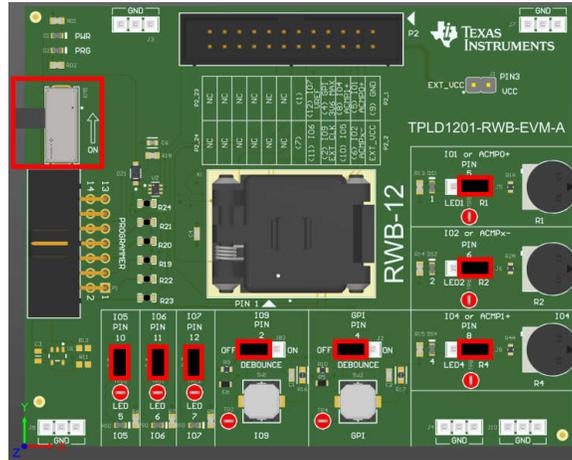
图 3-9. 演示配置中使用的接头和开关
