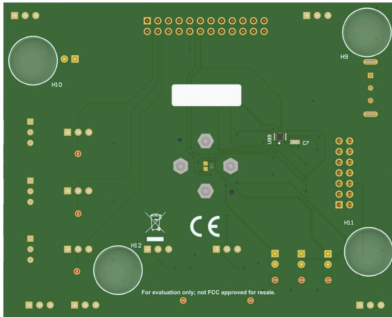
图 4-4. TPLD1201-RWB-EVM 电路板底层
