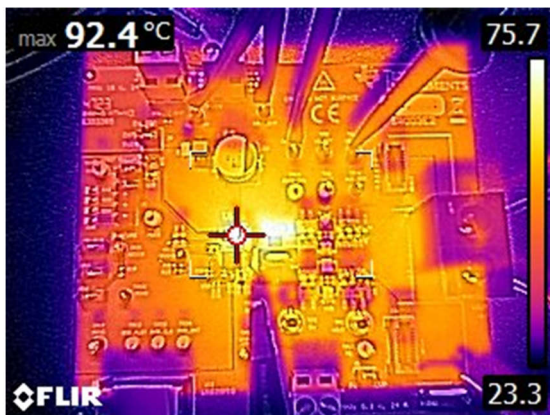
图 4-23. 热特性, 800kHz FCCM, 内部 LDO, 35A 负载, 无气流, 浸泡 10 分钟
