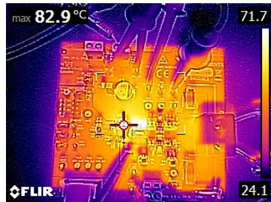
图 4-22. 热特性, 600kHz FCCM, 外部 5V 辅助电源, 35A 负载, 无气流, 浸泡 10 分钟
