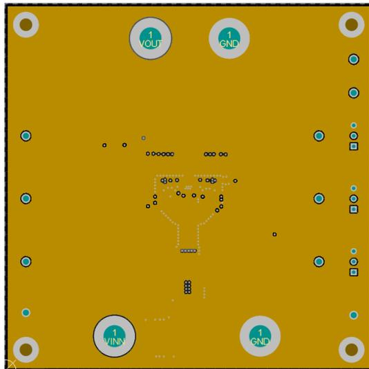
图 4-3. PCB 接地层 ( 顶层正下方 )
