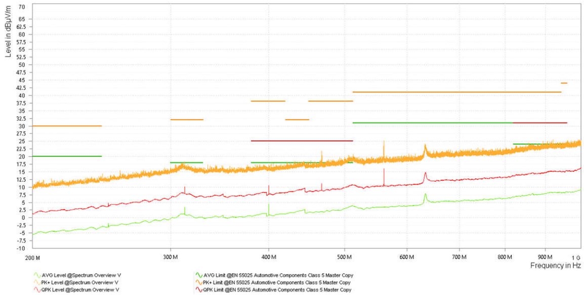
图 4-35. 使用垂直天线的辐射发射低功耗模式：200MHz 至 1GHz
