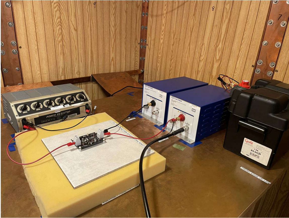
图 4-18. 传导发射测试设置
