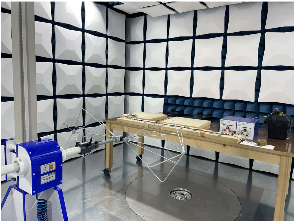
图 4-26. 使用双锥天线的辐射发射设置 : 30MHz 至 200MHz
