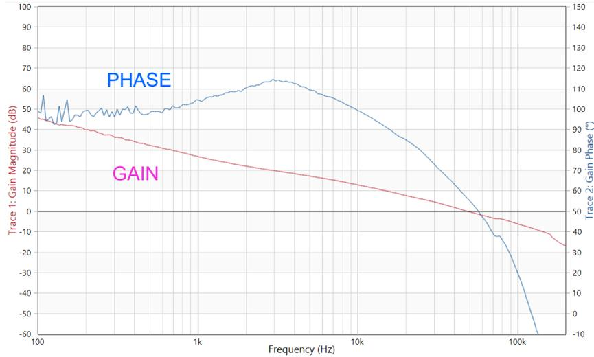
图 3-11. 波特图， $V_{\text{SUPPLY}} = 48\text{V}$ ， $V_{\text{LOAD}} = 12\text{V}$ ， $I_{\text{LOAD}} = 8\text{A}$
