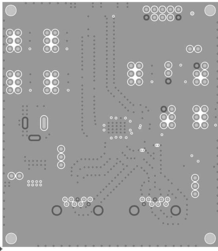
图 3-8. TUSB1021Q1-EVM PCB 第 5 层 ( 接地 )
