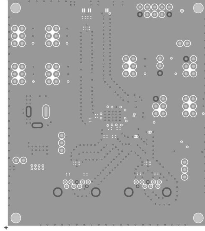
图 3-5. TUSB1021Q1-EVM PCB 第 2 层 (接地)
