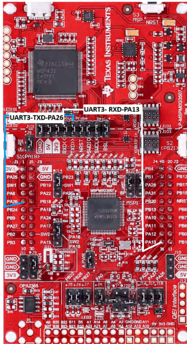
图 2-5. LP-MSPM0G3507 反向通道连接到 UART3 [在 DRV8316 工程中 UART 3 端口用于串行通信]
