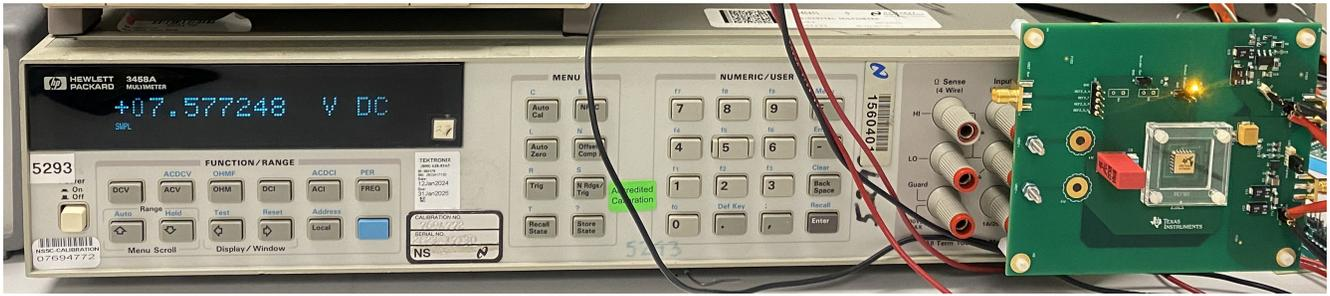
图 2-3. REF8EVM DMM 直接连接
