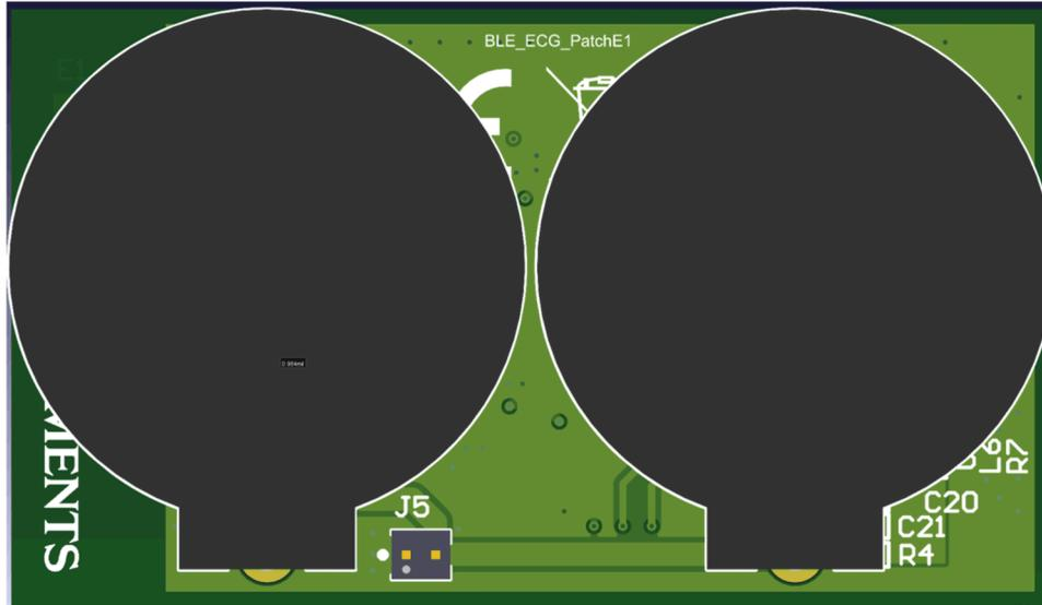
图 3-3. BLE 板底视图 (带有纽扣电池座)
