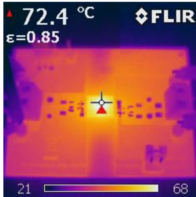
图 3-24. UCC33421-Q1 VINP=5.0V , VCC=5.0V , I OUT =300mA , P out =1.5W , TA=25°C
