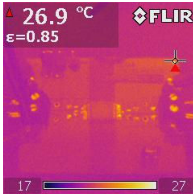
图 3-28. UCC33421-Q1 VINP=5.0V , VCC=5.0V , I OUT =0mA , P out =0W , TA=25°C
