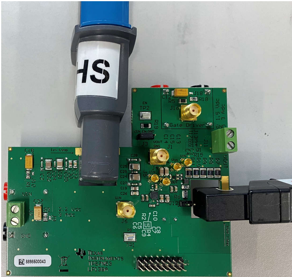
图 2-2. 连接了电流探头的 TPS7N53EVM
