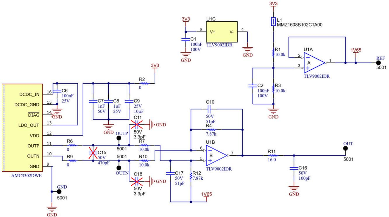
图 2-3. AMC-AMP-50A-EVM 隔离式放大器 (AMC3302) 模拟输出
