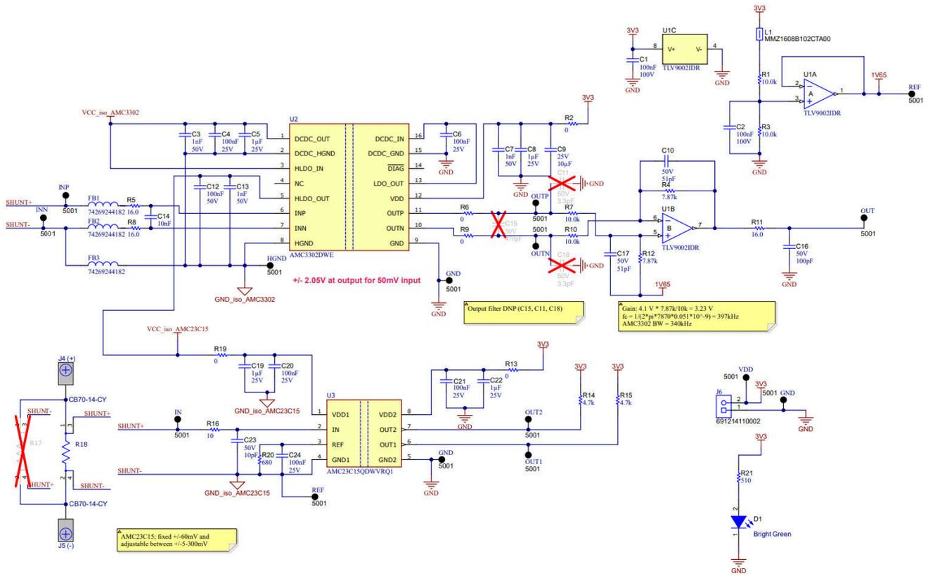
图 5-1. AMC-AMP-50A-EVM 原理图
