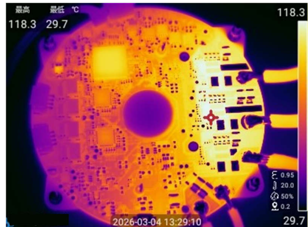
图 4-12. DRV7167 在 14A RMS 、80kHz PWM 时的热成像图
