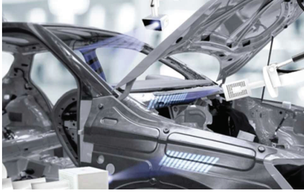
图 6. 3D 结构光扫描在汽车定位检测中的应用
