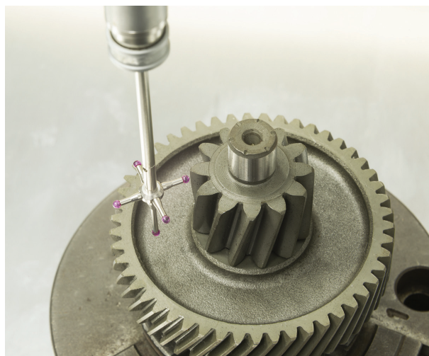
图 1. 坐标测量机探头示例
