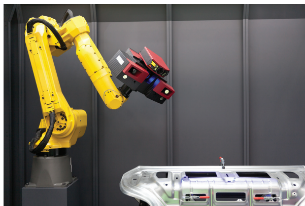
图 5. 带有 3D 扫描仪的机器人手臂
