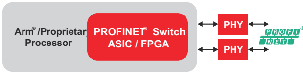
图5. 与采用处理器的集成式 PROFINET 交换机
